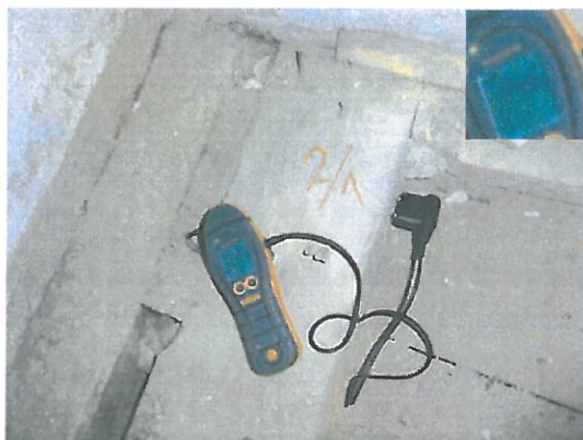
Fot. 11, 12 Badanie wilgotności belek w miejscu ich oparcia na ścianie. Wilgotność strukturalna drewna: 10,0-14,6% - drewno suche.
