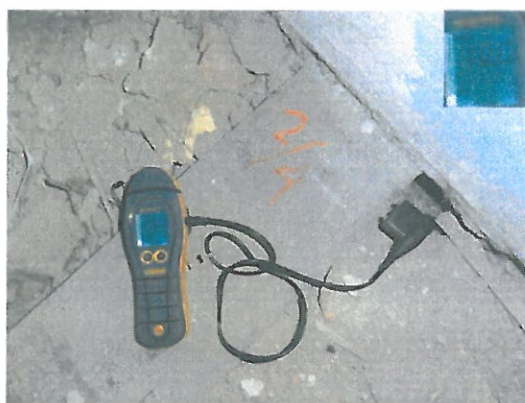
Fot. 11, 12 Badanie wilgotności belek w miejscu ich oparcia na ścianie. Wilgotność strukturalna drewna: 10,0-14,6% - drewno suche.
